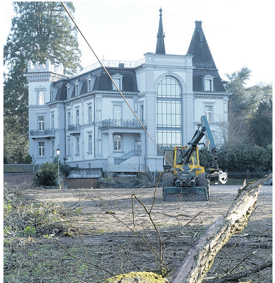
Mit dem «HSM-Schlepper» und einer Seilwinde werden die Bäume beim Fällen aus dem Hang hochgezogen. Im Hintergrund die «Villa Himmelrych».
